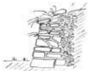
Degrado diffuso del coronamento, della base e di una parte superiore del muro
