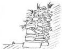
Degrado diffuso del coronamento, della base e di una parte superiore del muro
